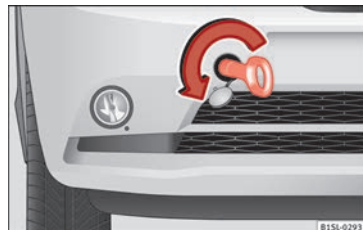
Bild 58 Höger sida på stötfångaren fram: fäs- te för bogserlina monterat.
