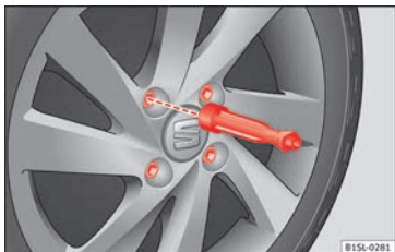
Bild 57 Byta hjul: skruva loss hjulbultarna med hjälp av hylsan i ände av hylsnyckeln.
