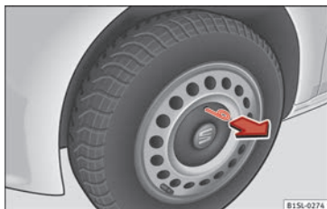
Bild 50 Ta bort navkapseln från hjulsidan (av stål)
