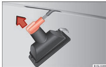
Bild 91 Registrerings-skyltbelysning: Ta bort lamphållaren. »
