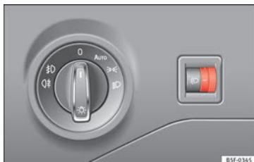
Bild 140 Intill ratten: Räckviddsreglering för strålkastare
