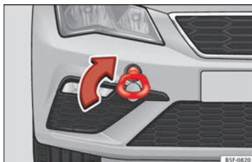
Bild 97 Höger sida på stötfångaren fram: fäste för bogserlina monterat
