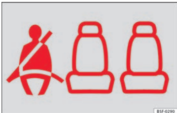
Bild 87 Instrumentpanelen: höger baksäte är belagt och motsvarande lampa för fastspänt säkerhetsbälte visas på displayen
