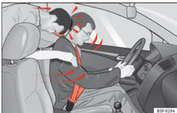
Bild 90 Passageraren i baksätet som inte använder säkerhetsbälte kastas framåt med en våldsam kraft och träffar föraren som använder säkerhetsbältet
