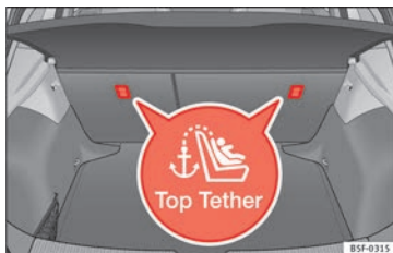
Bild 32 Top Tether-ringarnas placering på baksätets baksida
