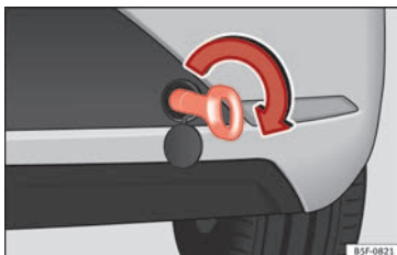
Bild 99 Höger sida på den bakre stötfångaren: fäste för bogserlina monterat
