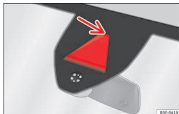
Bild 214 I vindrutans synfält för lane assist-systemets kamera
