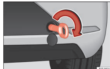
Bild 76 Höger sida på den bakre stötfångaren: fäste för bogserlina monterat
