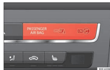
Bild 93 Signallampa för att inaktivera passagerarkrockkudden fram på instrumentbrädan
