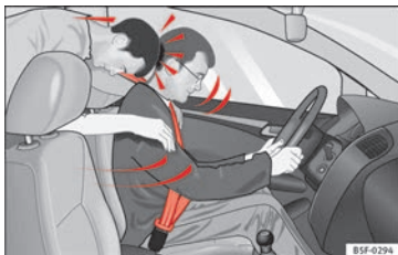
Bild 91 Passageraren i baksätet som inte använder säkerhetsbälte kastas framåt med en våldsam kraft och träffar föraren som använder säkerhetsbältet.
