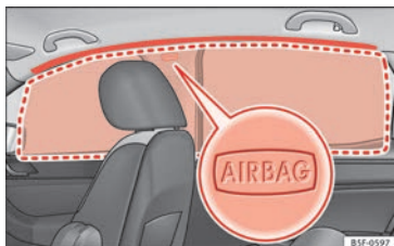
Bild 28 Placering av krockkuddar som skyddar huvudet.
