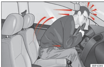
Bild 90 En förare som inte använder säkerhetsbältet kastas framåt med en våldsam kraft
