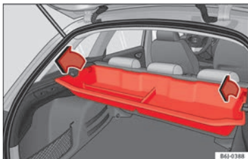
Bild 160 Bagageutrymme: ta bort förvarings-utrymme.
