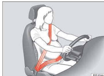
Bild 84 Positionering av säkerhetsbälte vid graviditet.
