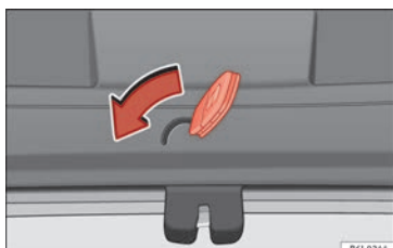
Bild 5 IBIZA ST: manuellt upplåsning av bakluckan.
