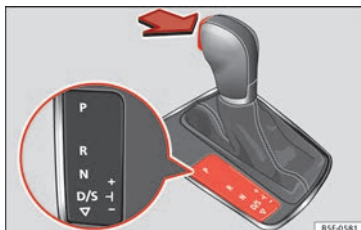
Bild 46 Automatisk växellåda: Väljarspakens lägen.
