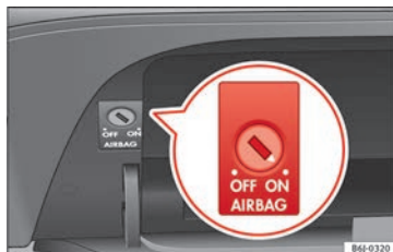
Bild 85 I handsfacket: brytare för aktivering och inaktivering av passagerarkrockkudden
