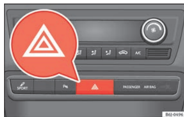
Bild 32 Instrumentbräda: knapp för varningsblinkers.
