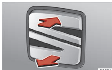
Bild 3 Baklucka: öppna från utsidan.
