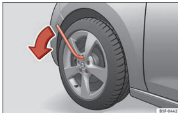
Bild 65 Hjul: lossa hjulbultarna.
