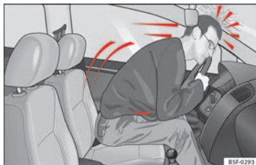
Bild 81 En förare som inte använder säkerhetsbältet kastas framåt med en våldsam kraft
