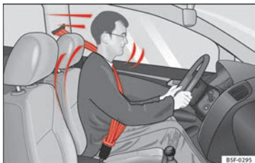
Bild 80 Förare som använder säkerhetsbältet på rätt sätt kastas inte framåt vid en plötslig inbromsning
