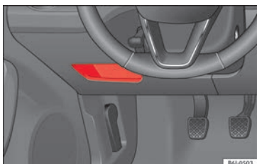
Bild 57 På instrumentbrädan på förarsidan: säkringsdosans lock
