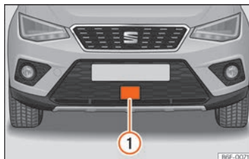
Bild 230 På den främre stötfångaren: radarsensor.
