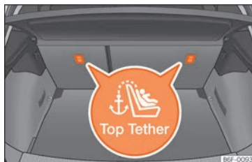
Bild 38 Top Tether-ringarnas placering på baksätets baksida.
