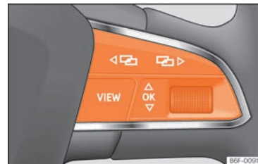
Bild 126 Höger sida av multifunktionsratten: knappar för instrumentpanelens menyer och informationsindikeringar.
