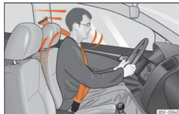
Bild 89 Förare som använder säkerhetsbältet på rätt sätt kastas inte framåt vid en plötslig inbromsning.
