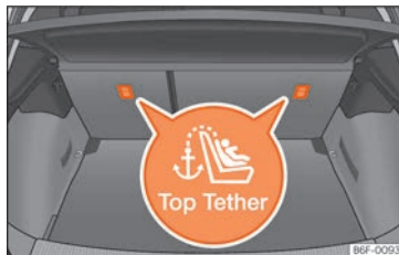
Bild 34 Top Tether-ringarnas placering på baksätets baksida.
