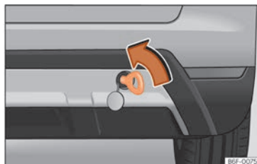
Bild 77 Höger sida på stötfångaren bak: fäste för bogserlina
