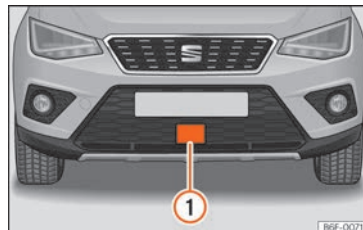
Bild 235 På den främre stötfångaren: radarsensor.
