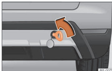
Bild 100 Höger sida på den bakre stötfångaren: fäste för bogserlina monterat.
