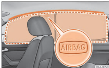
Bild 28 Placering och aktiveringsområde för huvudkrockkudden
