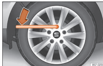
Bild 72 Däckbyte: lossa hjulbultarna.
