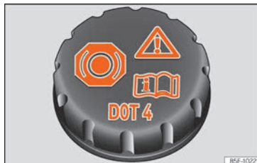
Bild 61 Motorrum: bromsvätskebehållarens lock.
