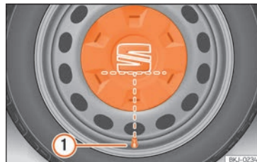
Bild 70 Korrekt placering av centrala hjulkåpan för stålfälgar
