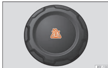
Bild 60 Motorutrymme: Lock till expansionskärlet för kylmedel
