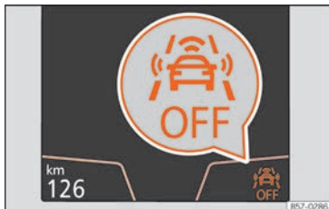
Bild 231 På instrumentpanelens skärm: meddelande om att Front Assist är fränkopplad.
