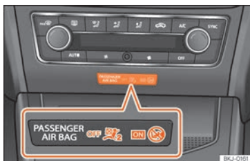
Bild 25 Mitten av instrumentpanelen: signal-lampa i mittkonsolen för inaktiverad främre passagerarkrockkudde
