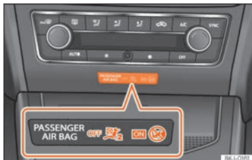
Bild 95 Mitten av instrumentpanelen: signal-lampa i mittkonsolen för inaktiverad främre passagerarkrockkudde
