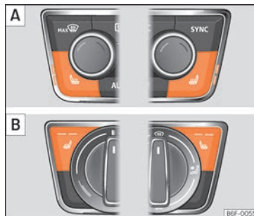
Bild 149 I mittkonsolen: brytare för sättsvärme fram A : version med Climatic B : version med manuell luftkonditionering.
